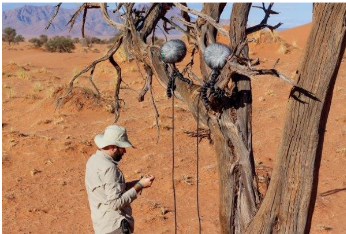
Georges liebstes Aufnahmerigg besteht aus vier MKH 8020, die um einen Baum herum platziert sind - eine Aufnahme mit dem Kopf
